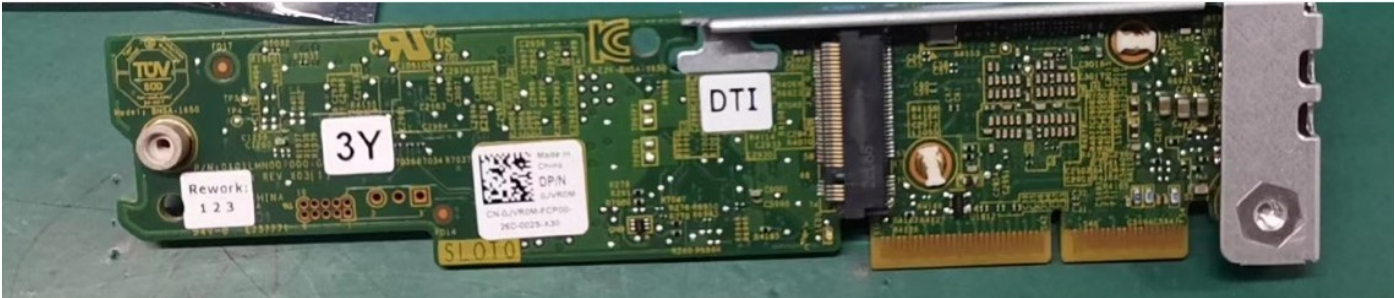
Ilustración 12. Controladora BOSS-N1 para configuraciones de 4 unidades de 3,5 pulgadas, 8 unidades de 2,5 pulgadas y 10 unidades de 2,5 pulgadas
