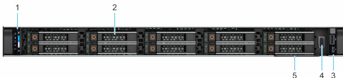
Ilustración 3. Vista frontal de un sistema de 10 unidades de 2,5 pulgadas
