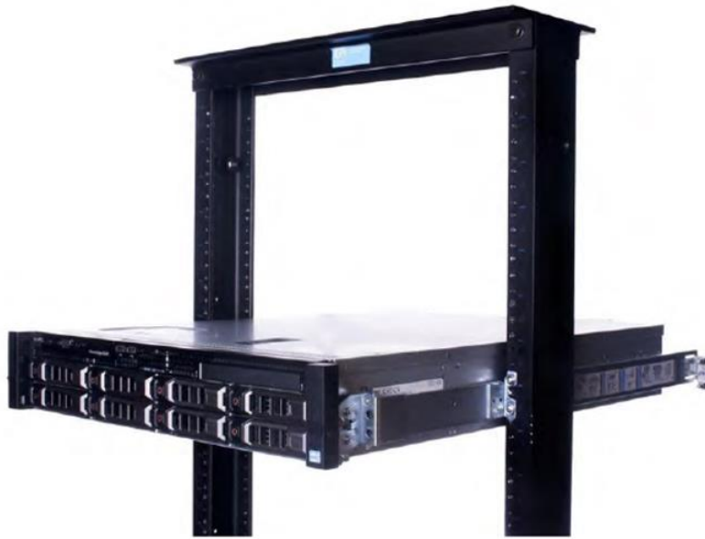
Ilustración 23. Rieles estáticos en una configuración de 2 postes de montaje central
