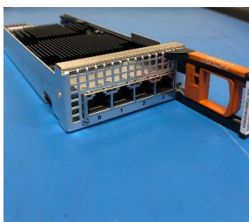
Figure 34. 10 GbE BASE-T I/O module
