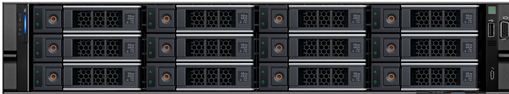
Abbildung 4. Vorderansicht eines Systems mit 12 x 3,5-Zoll-Laufwerksystemen
