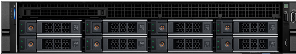
Abbildung 5. Vorderansicht eines Systems mit 8 x 3,5-Zoll-Laufwerksystemen
