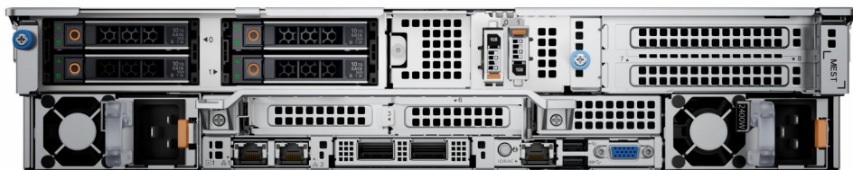
Abbildung 11. Rückansicht des Systems mit 4 x 2,5-Zoll-Laufwerksmodul
