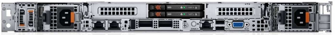
Abbildung 9. Rückansicht des Systems mit 2 x E3.S-Laufwerkssystem (hinten)
