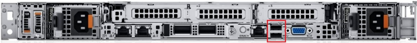
Abbildung 43. Hinterer USB-Anschluss des R6615-Systems
