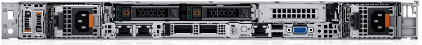
Abbildung 7. Rückansicht des Systems mit 2 x 2,5"-Laufwerkssystem (hinten)
