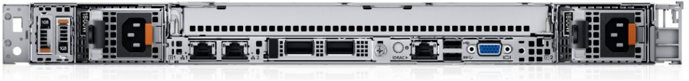
Abbildung 6. Rückansicht des Systems ohne Riser
