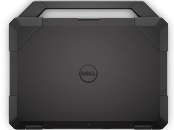
**Kein Eindringen von Staub oder Wasser:** Alle Einstiegspunkte sind durch mechanische Klappen und Eindringenschutz gemäß IP54 geschützt, damit weder Staub noch Nässe eindringen können. Die einstellbare Tastatur mit RGB-Hintergrundbeleuchtung ist vollständig geschützt und wasserabweisend. Integrierte Sicherheitsfunktionen wie Smartcard- und Fingerabdruck-Lesegeräte lassen unbefugten Benutzern keine Chance.
