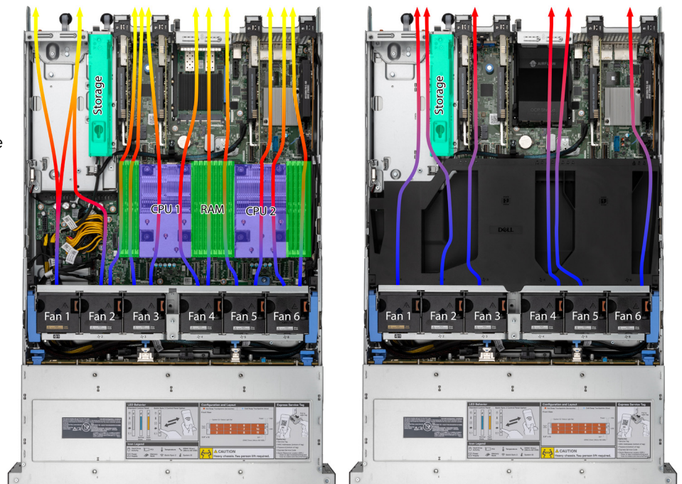
Abbildung 2: Hier ist das Layout der Hauptplatine des getesteten Dell PowerEdge HS5620 dargestellt mit der unteren thermischen Schicht (links) und der oberen thermischen Schicht (rechts), die vom Gehäuse getrennt werden. Wir haben Komponentenbeschriftungen und Pfeile hinzugefügt, die die Luftstromrichtung von den Lüftern anzeigen, kältere Luft ist blau und violett gekennzeichnet, heißere Luft rot, orange und gelb. Quelle: Principled Technologies.
