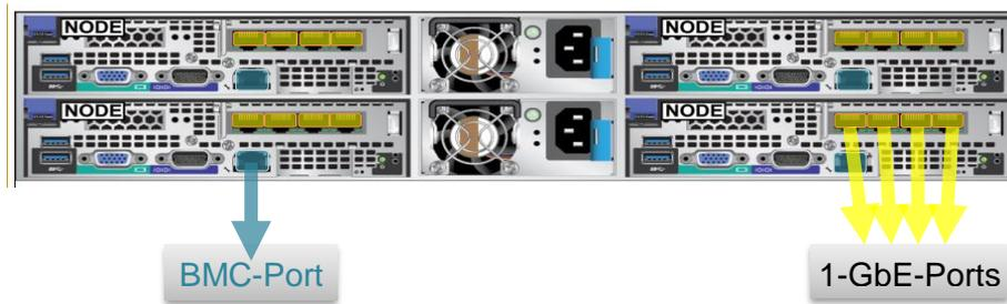
Abbildung 2. VxRail-Appliance der G-Serie mit vier Nodes mit 1-GbE-Ports auf jedem Node
