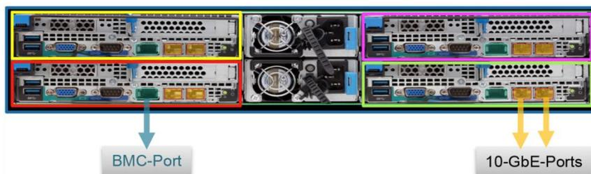
Abbildung 1. VxRail-Appliance der G-Serie mit vier Nodes mit 10-GbE-Ports auf jedem Node
