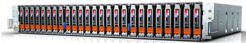
Zusätzliche Scale-up-Kapazität wird zum VMAX 250F-System mithilfe von Flash Capacity Packs in Schritten von 11 TBu hinzugefügt. Die Skalierung ist bis auf eine maximale effektive Kapazität von 500 TBu pro Brick möglich. Eine VMAX 250F mit zwei Bricks kann unter Verwendung eines halben Racks (20 HE) auf einer einzigen Flächeneinheit bis zu einer Gesamtkapazität von 1 PBe hochskaliert werden.
